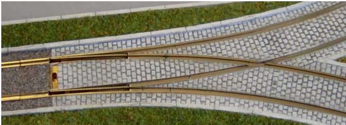
Beispiel einer Selbstbauweiche aus Rillenprofilen und einem Stückchen Schotter
