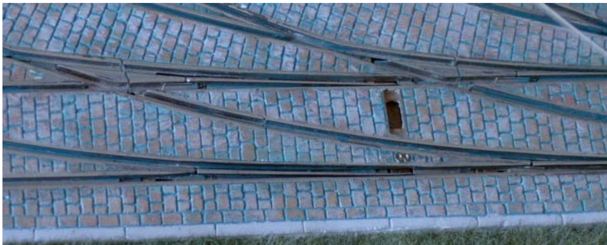
Einfahrt zum Betriebshof – solche Weichen kann man nur selbst bauen, hier nach der Methode "zwei Profile nebeneinander"
